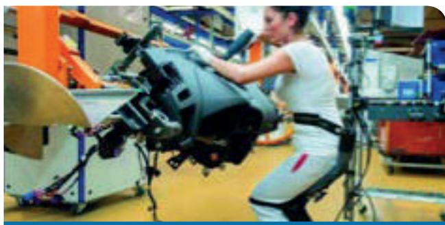
Pour soulager ses opérateurs et améliorer leur productivité, Audi teste des exosquelettes sur des lignes d'assemblage. Fixés sur les jambes, au niveau des hanches, des genoux et des chevilles, ils sont déclenchés à volonté par l'opérateur. Le poids du corps est alors transmis vers les talons des chaussures, et l'utilisateur est soulagé, comme par une chaise glissée sous lui au bon moment.
