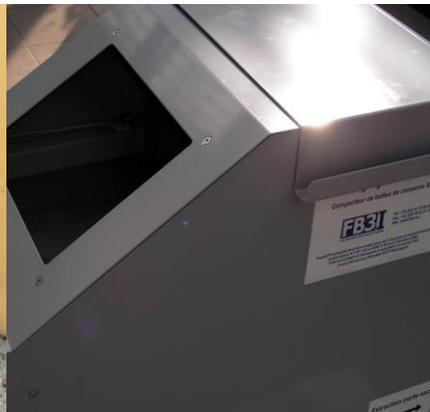
Fenêtre de contrôle de compactage
