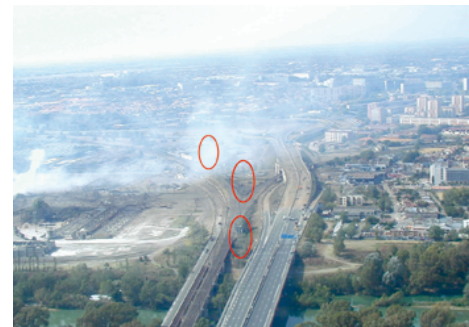
Le flux du vent d'Autan tracé par les fumées postcatastrophe. Il passe sur les pylônes de la ligne haute tension 63 kV des deux côtés de la RN20 (ovales rouges). Axe de vue Nord-Est Sud-Ouest.
